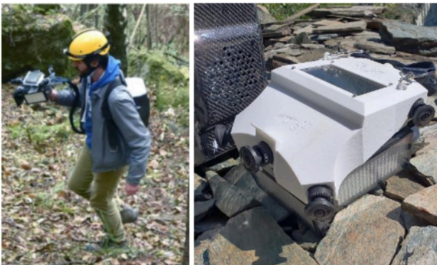
Figura 3. Attività di rilievo con il sistema multi-camera Ant3D e un'immagine di dettaglio dello strumento.
