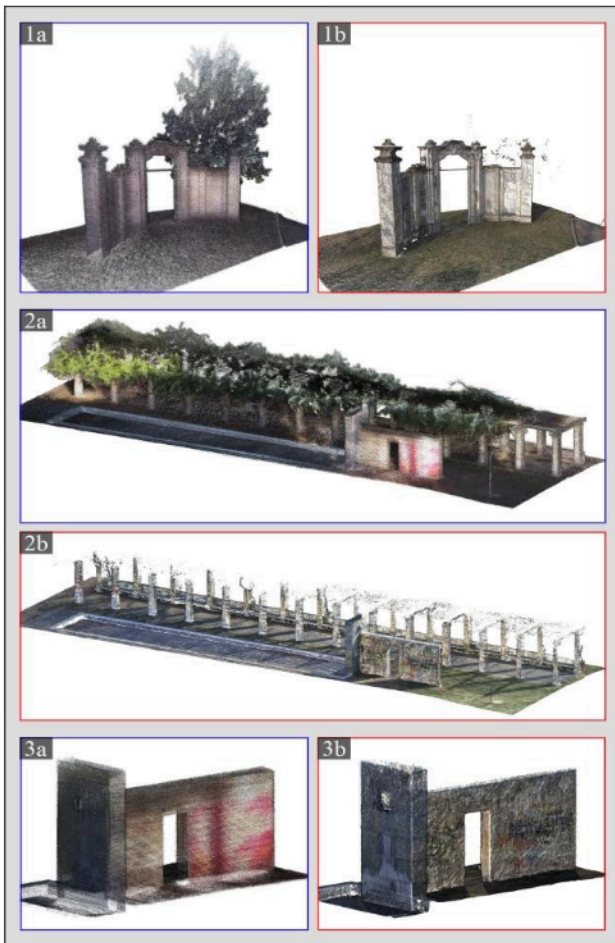
Figura 6. Confronto tra le due nuvole di punti ottenute di alcune strutture artificiali. Una struttura a portale (1a, 1b), una struttura a gazebo (2a, 2b) e lo zoom di una parte della struttura a gazebo (3a, 3b). I dati ricavati dal rilievo Heron Backpack sono bordati in blu, mentre in rosso quelli relativi ad Ant3D.
