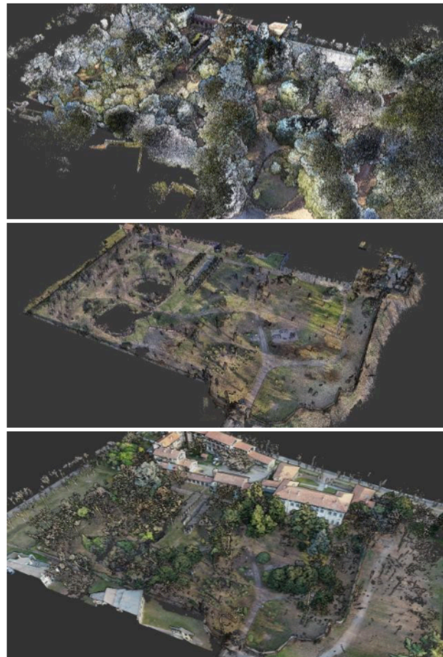
Figura 5. Nuvole di punti ottenute per i vari rilievi effettuati: Heron Backpack (in alto), Ant3D (al centro), UAV (in basso).
