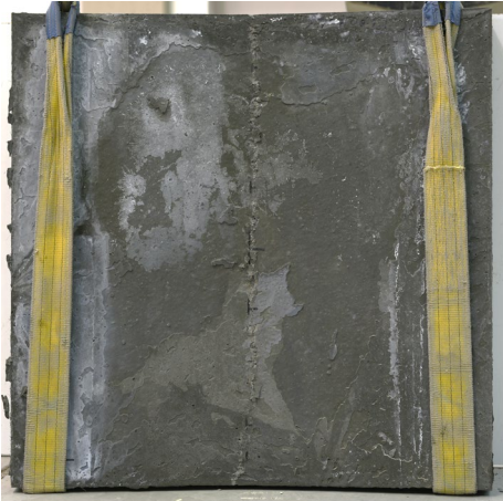
#8: P=99.0 kN, \tau=0.52 MPa, s=1.8 \mu\text{m} , w=13.0 mm
