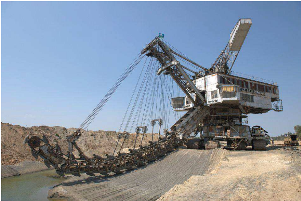
Figura 1: Escavatore a catena di tazze
