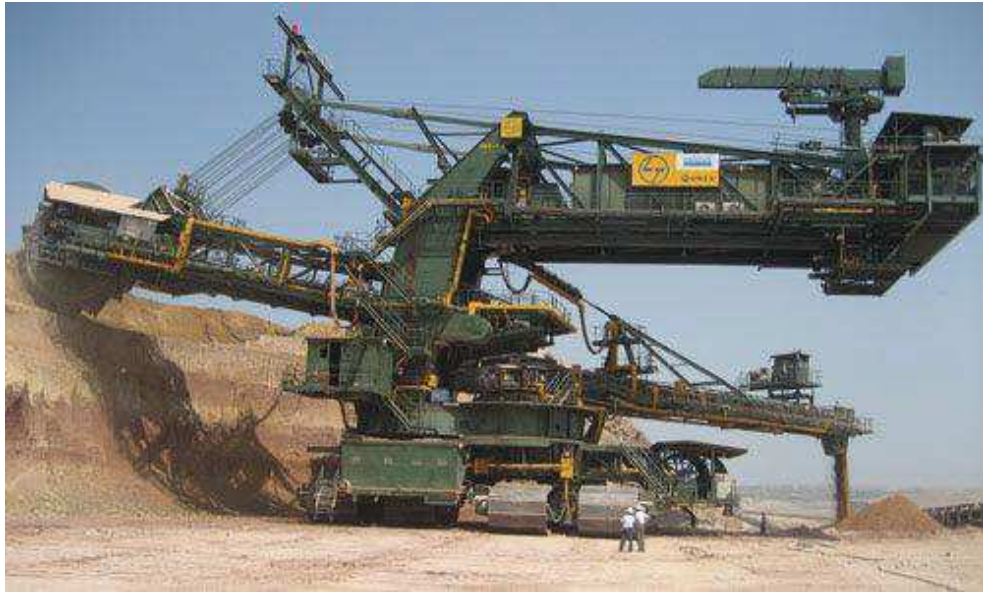
Figura 2: Escavatore a ruota di tazze
