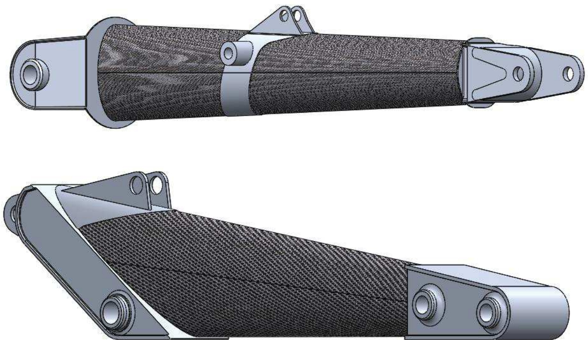
Figura 32: Modelli solidi del boom (a) e dello stick (b) in materiale composito
