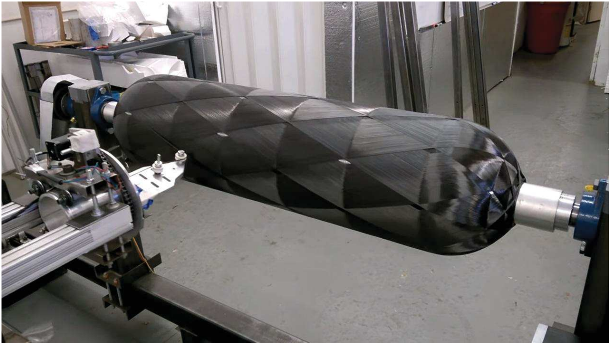
Figura 108: Componente in fase di realizzazione mediante la tecnica del filament winding
