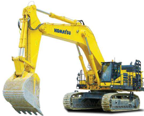
Figura 4: Escavatore a benna rovescia
