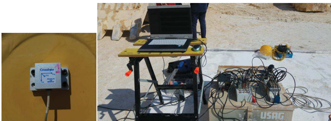
Figura 14: Accelerometro (a) e strumentazione utilizzata (b)
