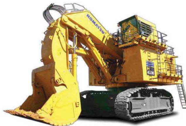
Figura 3: Escavatore a benna dritta
