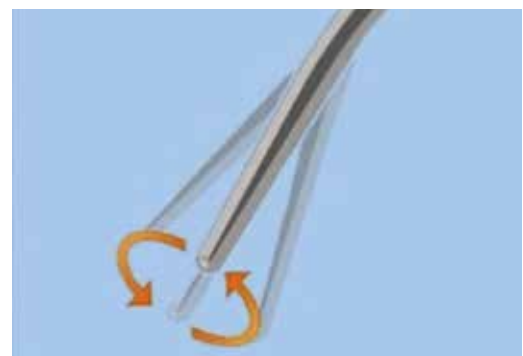
FIG. 1 Le vibrazioni longitudinali viaggiano dal pacco lamellare di nichel attraverso il corpo di connessione fino alla punta dell'inserto. I punti arancione denotano i punti di non vibrazione o non movimento, definiti come punti nodali o antinodi.
