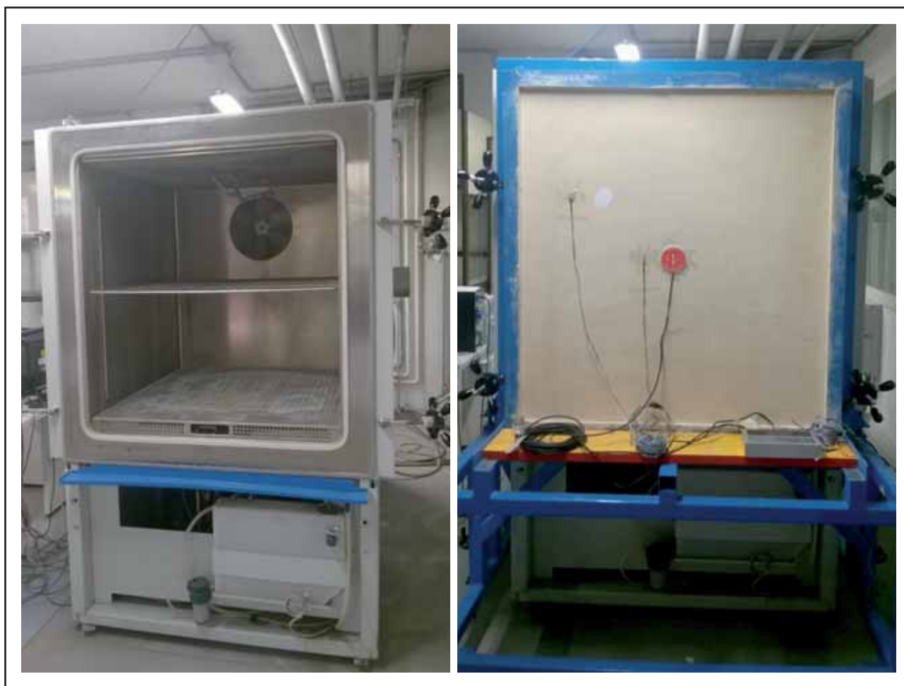
Fig 1 – Setting sperimentale (camera climatica e campione strumentato)
