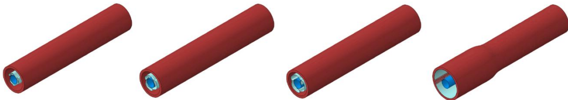
Figura 6: fasi del gonfiaggio all'interno di un'arteria, vista di una sezione longitudinale
