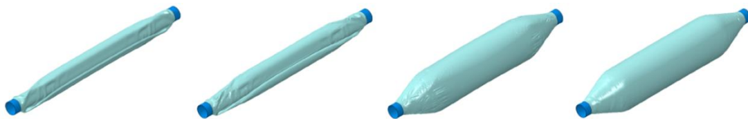
Figura 5: Progressivo gonfiaggio libero del palloncino
