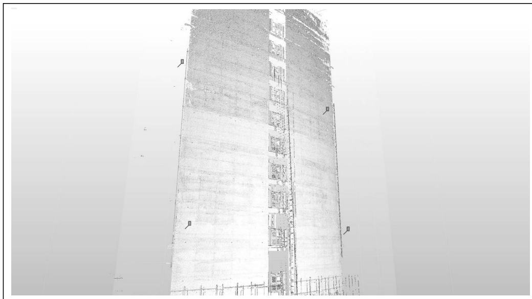
Figura 6 – Scansione realizzata con Faro Photon e trattata con “ Faro JRC 3D Reconstructor – Construction ”.
