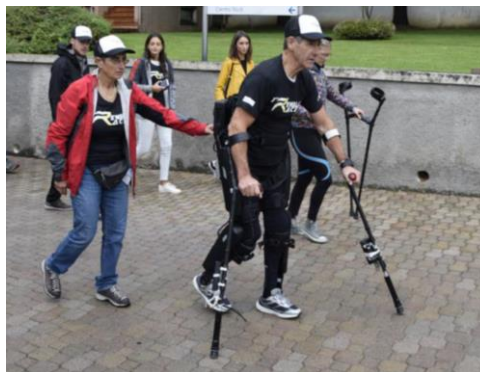
Figura 1 – Esoscheletro Rewalk e stampelle strumentate durante l'utilizzo all'aperto di un utente esperto.
