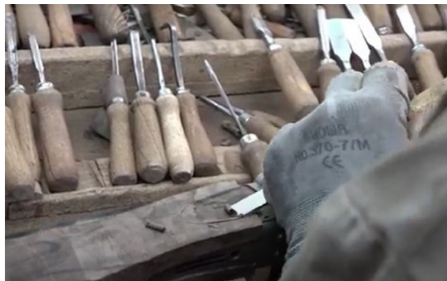
Fig. 4. Materiale multimediale: fase di predisposizione nel calcio in legno degli spazi per alloggiare parti metalliche.
