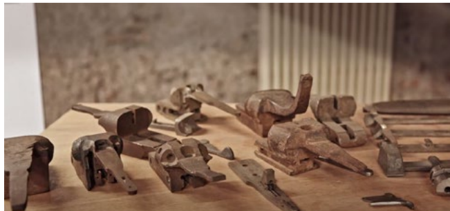
Fig. 3. Modelli di bascule e chiavistelli ed altri elementi parti di fucile utilizzati in fase di lavorazione come esempi.
