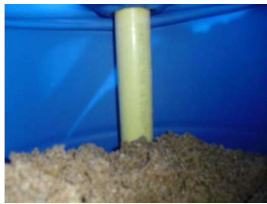
Fig. 4.24: Strato superiore (sabbia)
