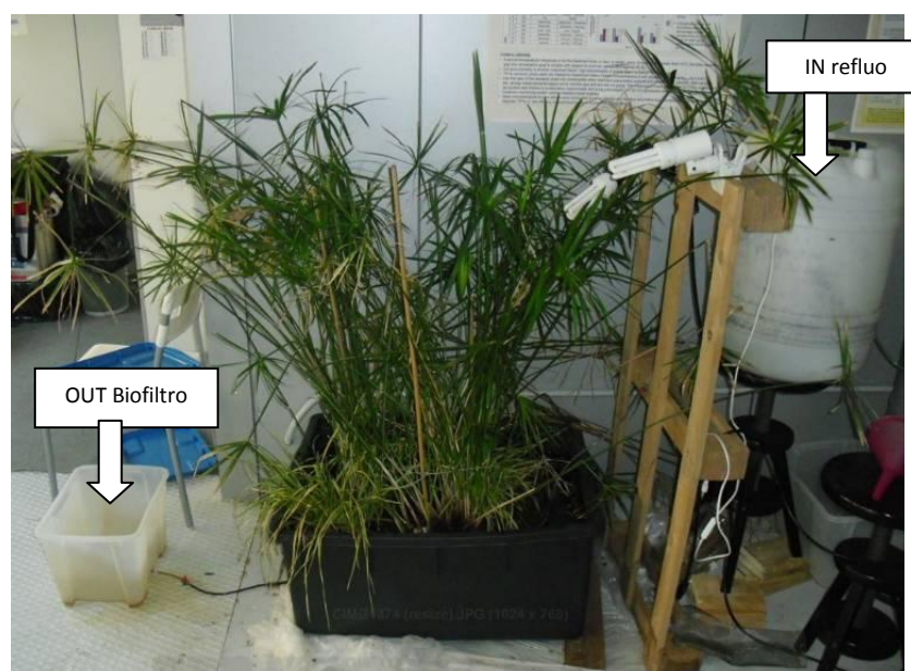
Fig. 3.10: Impianto pilota fitodepurazione in laboratorio a Pavia
