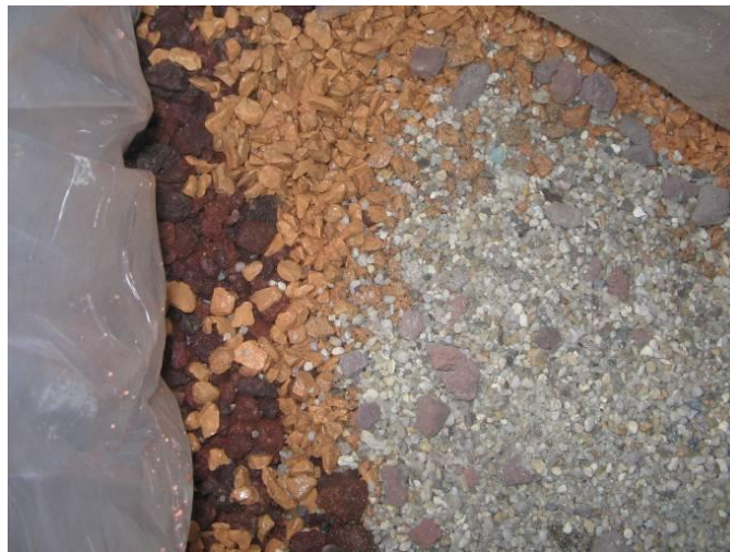
Fig. 3.9: Le diverse granulometrie del mezzo poroso utilizzato, si nota anche l'impermeabilizzazione il Celfan
