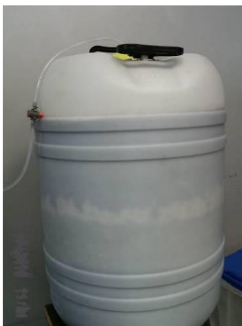
Fig. 3.11: Reattore dell'impianto anaerobico
