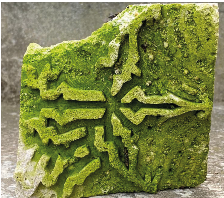
08. Piastrella in cemento colonizzata da parte di alghe verdi e muschi protonemata | Cement tile colonized by green algae and moss protonemata. Barbara Pollini e Tania Contardo
