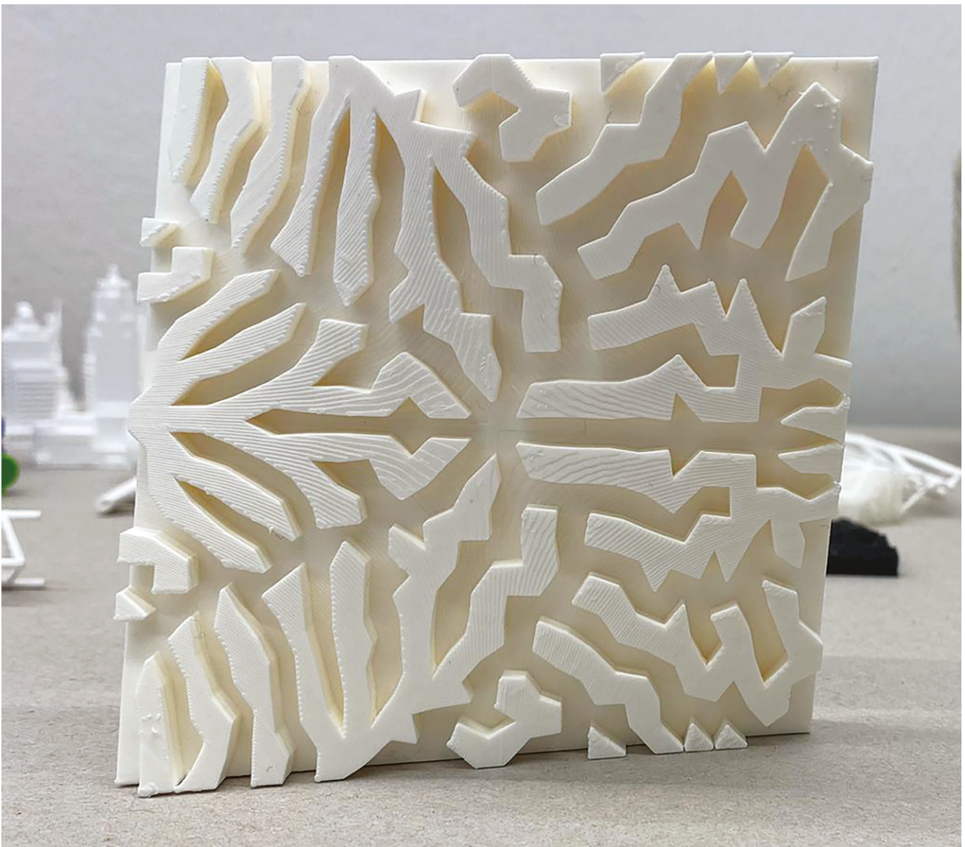
01. Stampo texture in steriolitografia | Texture mold in steriolithography. Barbara Pollini, Laboratorio LaborA, Politecnico di Milano
