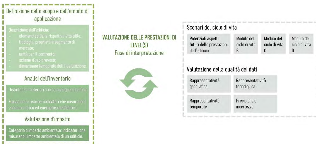
Figura 25. Fasi dello svolgimento di una valutazione del ciclo di vita nell'ambito del quadro Level(s). (elaborazione autori)
