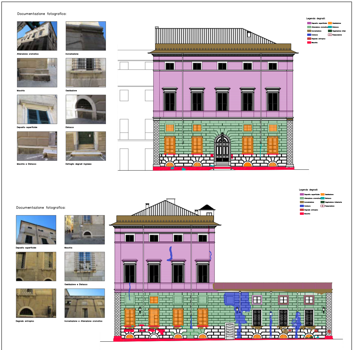
Fig. 9c-d – Arch. Caterina Marmorì, Analisi del degrado
