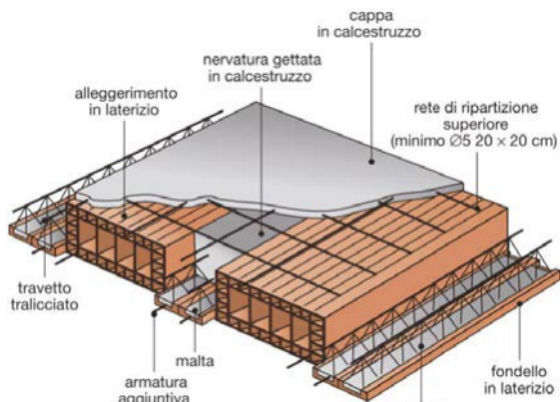
Solaio a doppio traliccio elettrosaldato.
