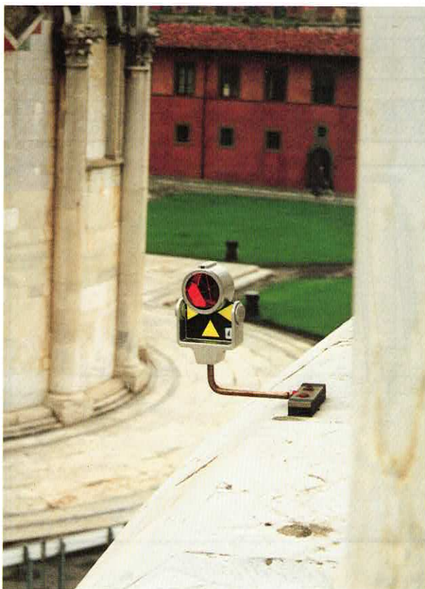
Fig. 21 - La mira ed il prisma riflettente posizionati sul lato ovest della Torre
