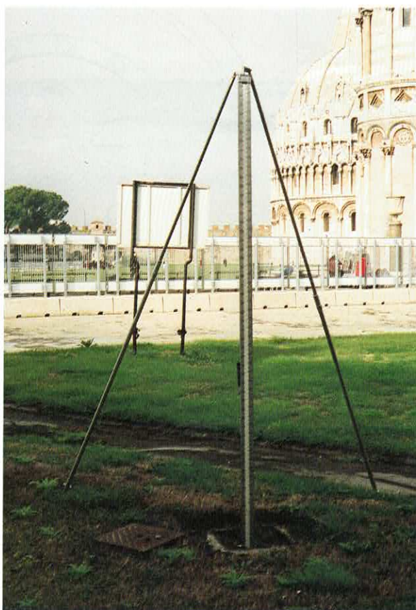
Fig. 9 - Immagine di una delle due stadiie, dotate di supporti telescopici di sostegno, utilizzate nelle operazioni di livellazione geometrica. Le stadiie hanno un'altezza di 3 metri e una graduazione mezzocentimetrata, adeguata alle caratteristiche del micrometro dell'autolivello Zeiss Nil , anch'esso mezzocentimetrato
