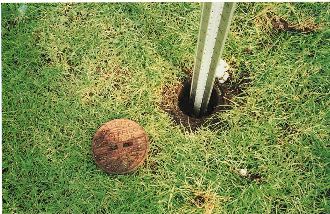
Fig. 6 – Stadia posizionata in corrispondenza di un caposaldo in ceramica situato nella Piazza dei Miracoli e protetto da un chiusino in ghisa
