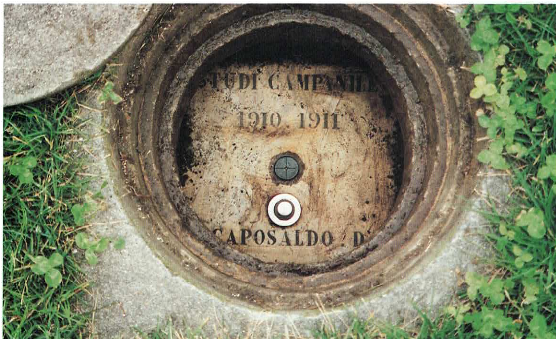
Fig. 4 – Immagine del caposaldo D con in primo piano il vertice planimetrico del 1911 (scuro) e il caposaldo altimetrico installato nel 1965 (chiaro)
