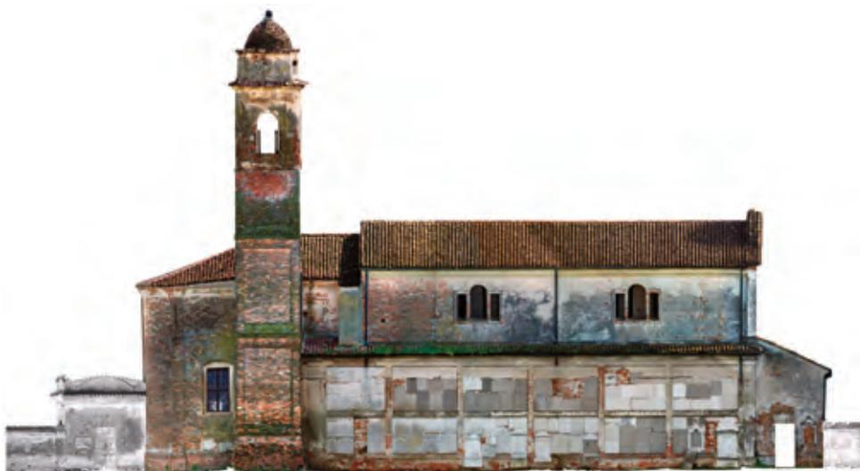
Fig. 15 – Esempio di ortofoto estratta da un modello tridimensionale a nuvola di punti di una architettura storica.
