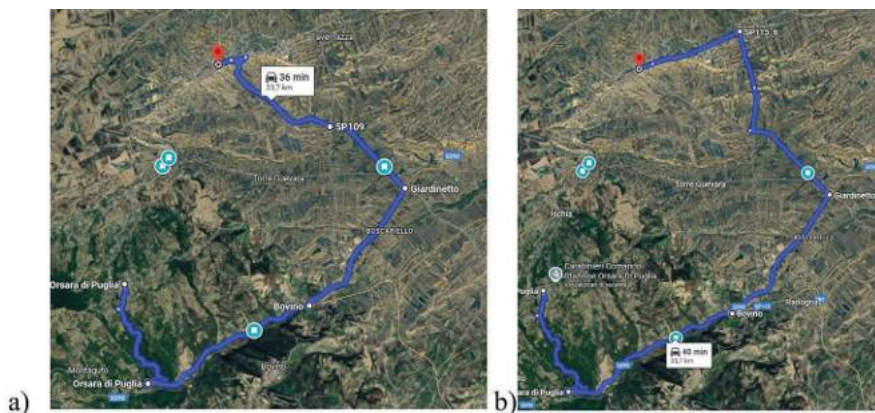
Figura 8.158 Identificazione delle due alternative di percorso all'interno della terza rete di bypass individuata a seguito dell'interruzione del manufatto, e relativi tempi di percorrenza.
