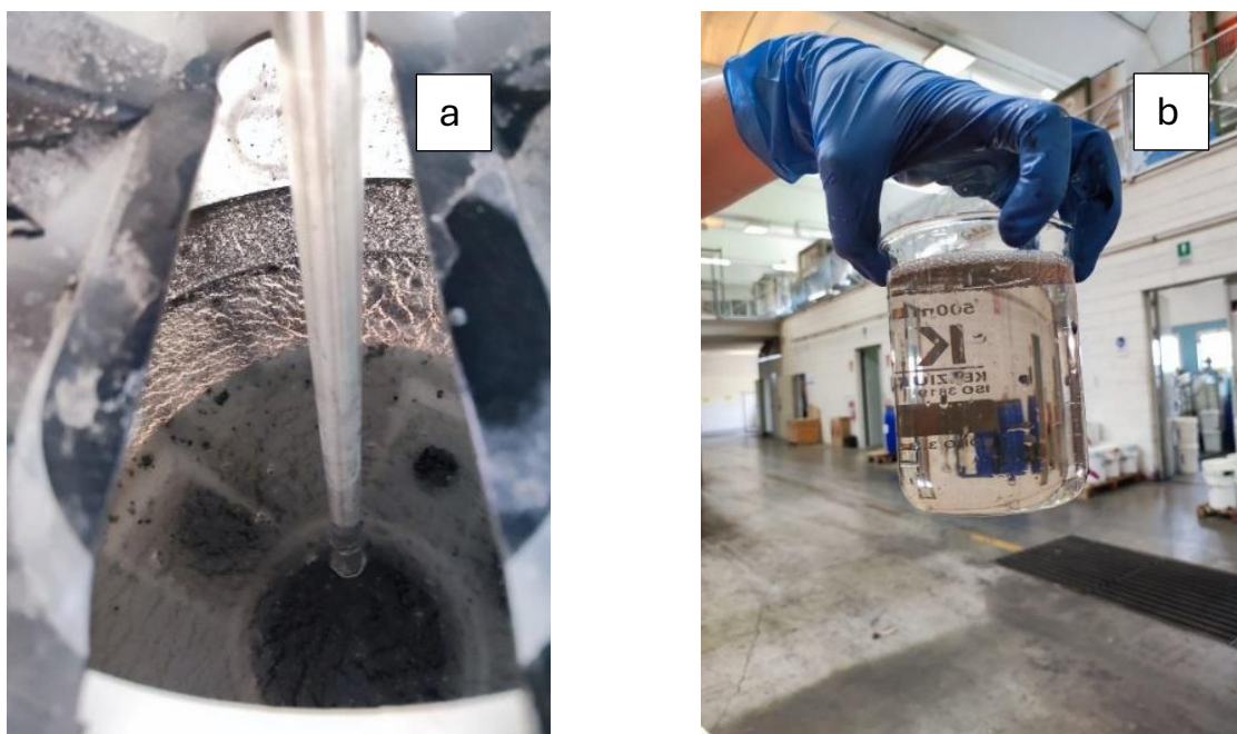
Figura 4.21. (a) Fase di miscelazione del refluo con chitosano, con formazione iniziale dei flocchi all'interno del reattore; (b) campione di acqua trattata post-filtrazione, caratterizzata da una colorazione giallastra e dalla presenza residua di solidi sospesi.
