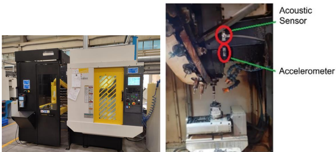
Figura 5.117: macchina Robodrill \alpha -D21MiB5 in azione con annessa isola robotizzata e interno della macchina utensile con i sensori accelerometro e di emissione acustica
