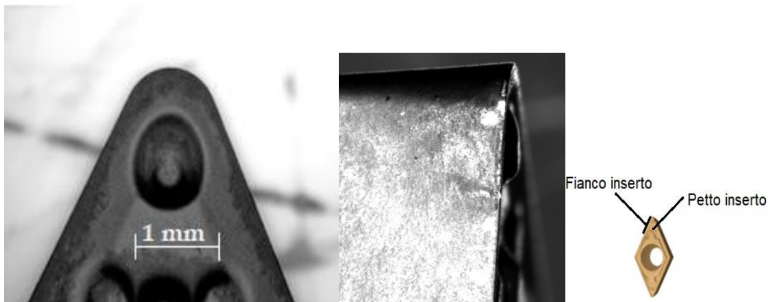
Figura 5.62: rappresenta il petto dell'inserto, il fianco dell'inserto e lo schema indicante le due parti.
