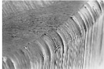
Figura 3.2: Usura di tipo abrasiva.
