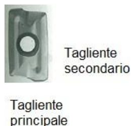
Figura 5.39: ingrandimento 0,65 con misura dell'usura VB. Tagliente principale e secondario
