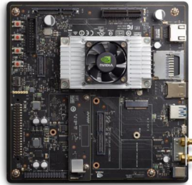
Fig. 1. La scheda NVIDIA Jetson TX2 montata su board Developer Kit.
